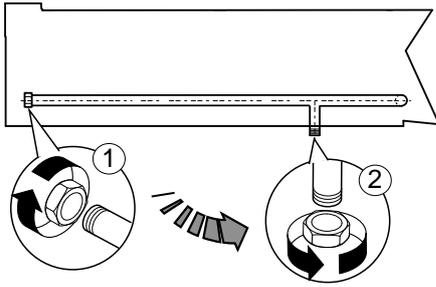
Una vez efectuada la instalación, compruebe que no existan pérdidas en los empalmes mediante una solución de agua y jabón.
