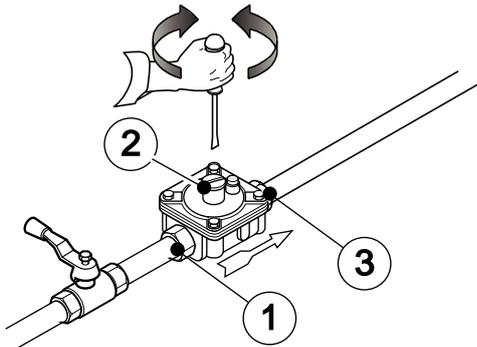
**Para Australia:** Ajuste la presión de la toma de prueba con los quemadores al máximo (consulte la tabla "B" en el Apéndice).
